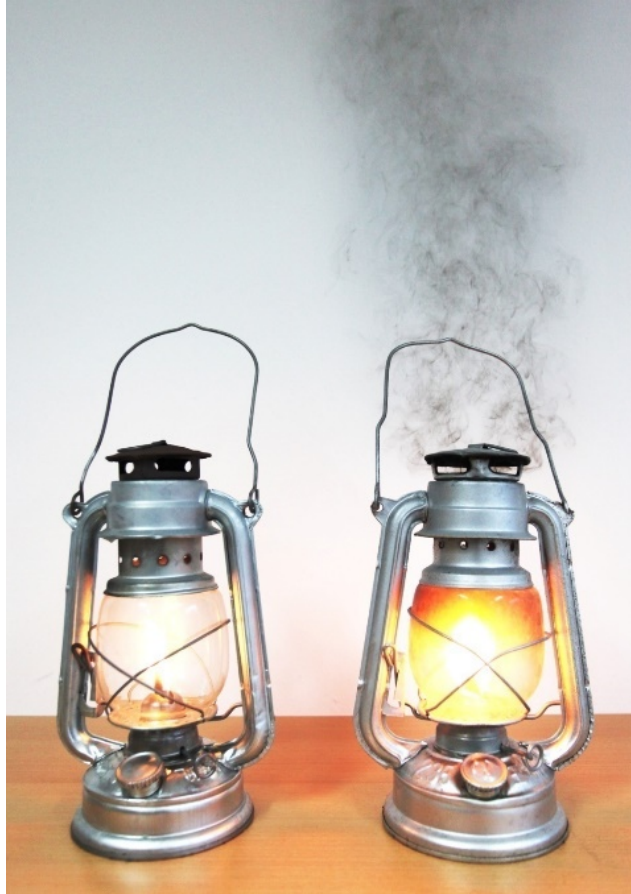
Abbildung 7: "Lampenexperiment" zum Vergleich von Winddiesel und historischen Treibstoffen
