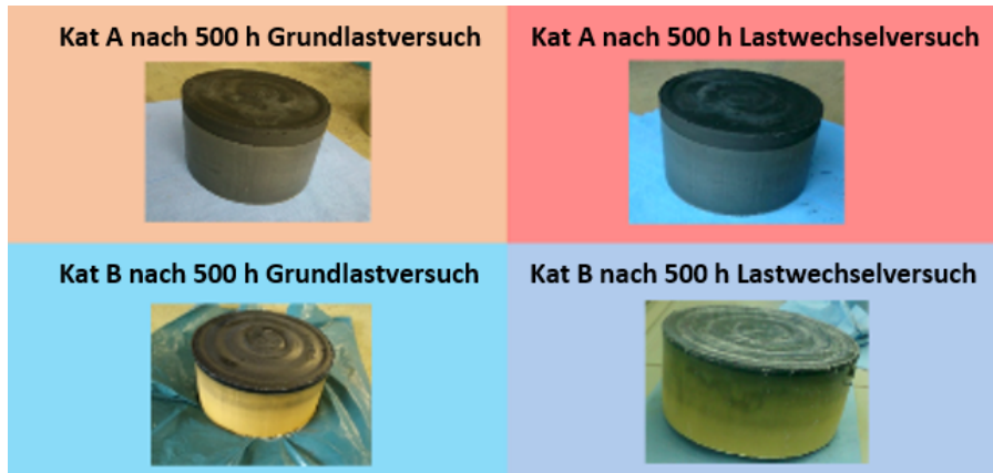
Abbildung 17: nach den Versuchen ausgeschmolzene Katalysator/Wachs-Kuchen
